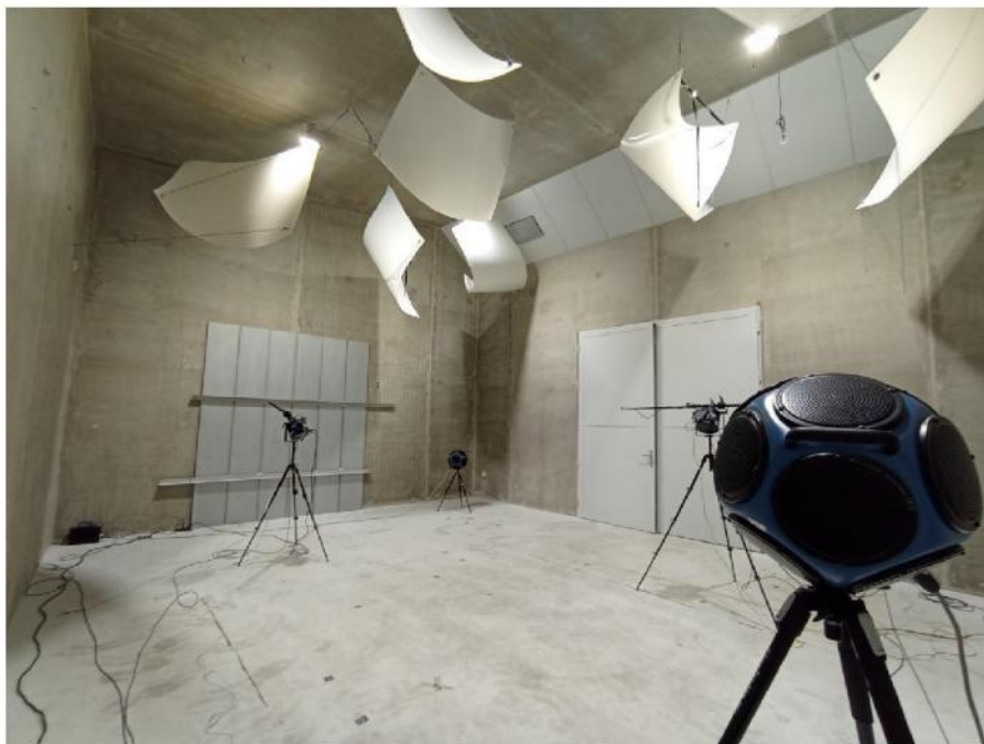
Fotografia 1 Rozmieszczenie pochłaniaczy w komorze pogłosowej
